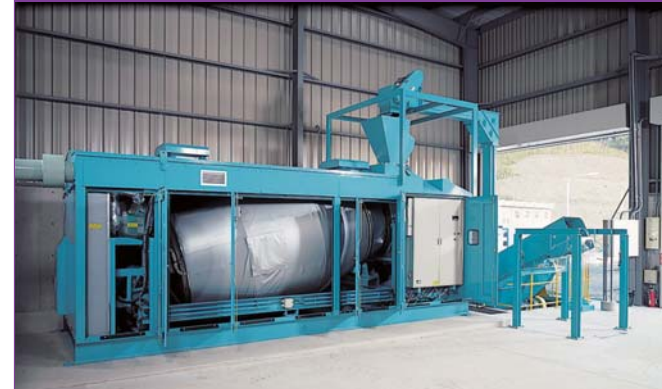
Bio-Mixer (rotating drum high speed fermentation unit) 生物搅拌机(容器旋转型高速发酵处理设备)
